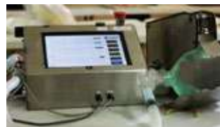
Ventilador mecánico en fase 2 de pruebas con modelo animal porcino
